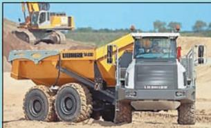
с колесной формулой 6x6 может перевозить до 30 т груза. Кузов имеет полезную вместимость 14,2 м куб. и при помощи мощной гидравлики поднимается на угол до 70 градусов всего за 12 секунд. Самосвал TA230 оснащен 10,5-литровым турбодизелем мощностью 367 л. с. и автоматической 8-ступенчатой коробкой передач. Максимальная скорость новинки составляет 57 км/ч.
