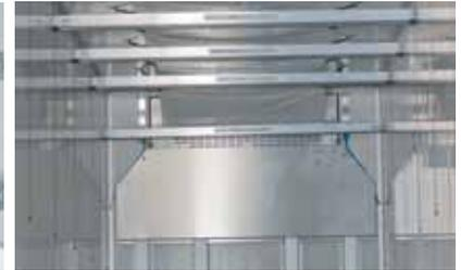
нов. Стальной лист покрыт изнутри жесткой ПВХ пленкой. Стенки толщиной 45 или 56 мм, верх толщиной 85 мм, а также основа толщиной 125 мм собственного производства обеспечивают низкую теплопередачу. Эта защита от влияния внешней температуры уменьшает потребление электроэнергии, экономя средства.
